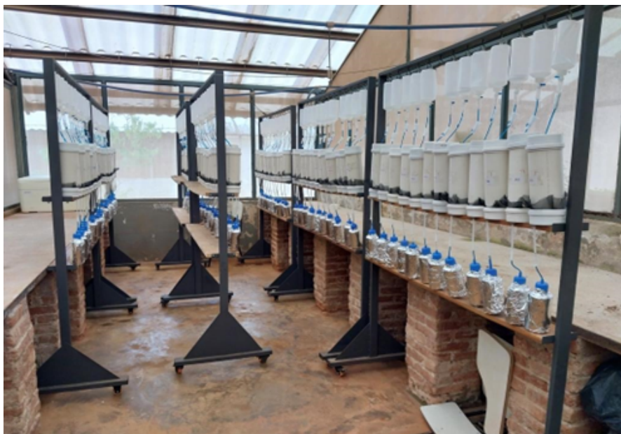
Figura 38: Visão geral do experimento que mostra o circuito de percolação de água em colunas de lixiviação.
